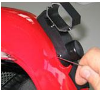
5. Introduire la vis de sécurité et vissée jusqu'en butée, puis dévisser un demi-tour
