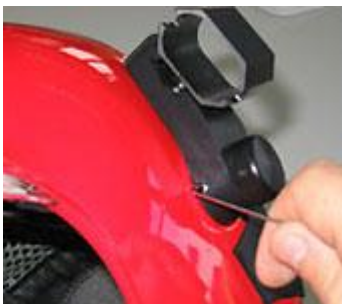
5. Sicherheits-Imbusschraube bis zum Anschlag hereindrehen und anschliessend eine halbe Umdrehung herausdrehen
