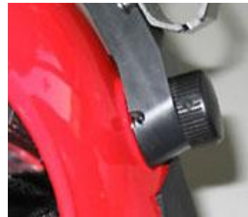
4. Schraube bis zum Anschlag anziehen, und Punkt an der Kerbe ausrichten
